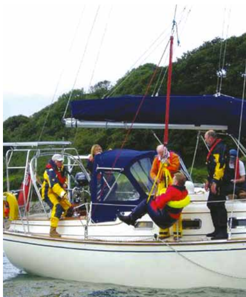
Wykorzystanie fału do podnoszenia ratowanego w pozycji półleżącej (widoczna dodatkowa pętla pod kolanami).
