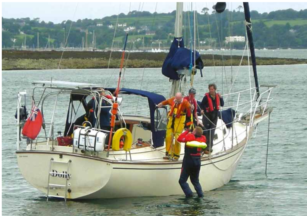
Wykorzystanie talii szotów grotu do ponoszenia ratowanego w pozycji pionowej (widoczna pętla lifeslingu i za bardzo uniesione ręce ratowanego grożące wyśliznięciem się z niej).
